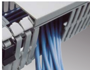
Jednotlivé lamely lze u kanálů řady BA7 jednoduše odlomit, aniž by v místě odlomení vznikly jakékoliv ostré hrany.
